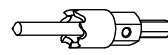
Drill miller with drill bit (2) Bohrspitze mit Fräse. Utensile con punta perforante (2)
